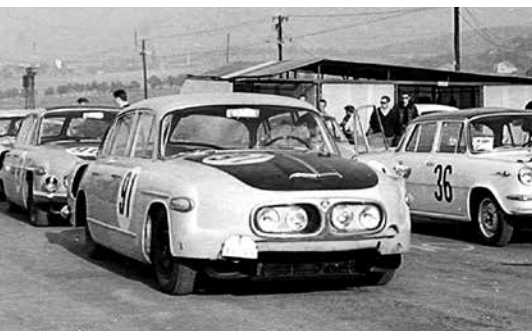
Náporový chladič oleje vpředu (Brno 1967)
